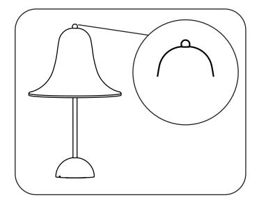
THE LIGHT INTENSITY OF THE LAMP CAN BE ADJUSTED BY TOUCHING THE DIMMER KNOB ON THE TOP OF THE LAMP.
